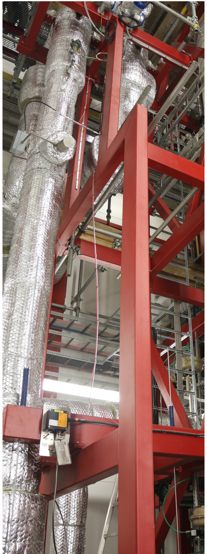
Ultraschall-Durchflussmessung eines Hochtemperatur-Gemisches aus Wasserstoff und Dampf
