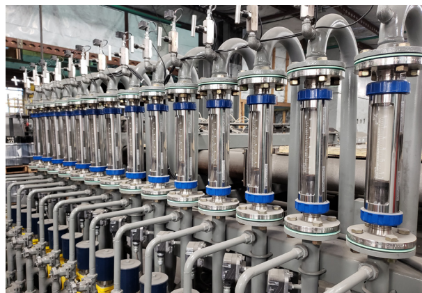
Wasserstoffdurchflussmessung mit dem Schwebekörper-Durchflussmessgerät VA 40
