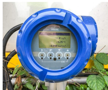
Messung des Gesamtverbrauchs an Wasserstoff mit dem Coriolis Masse-Durchflussmessgerät OPTIMASS 6400 (DN15)
